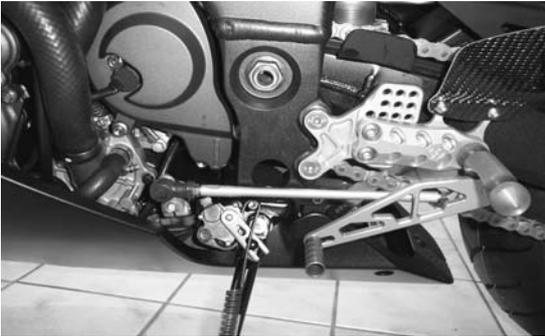
Vorgefertigte Anlagenhälfte links gem. Abbildung mittels Schrauben M8x25 DIN 7991 und Distanzscheiben DS20-8-6 am Rahmen anschrauben. Anzugs-Drehmoment 25 Nm. Schalthebel-Stellung mittels Schaltwelle USW04 einstellen.
