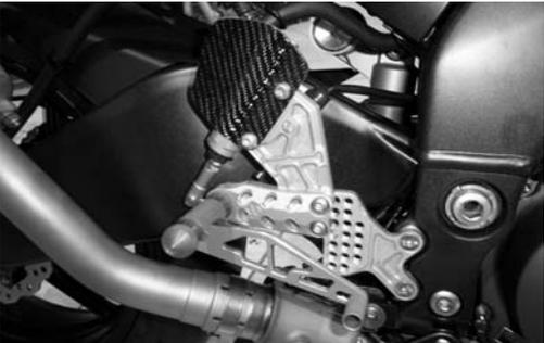
Einstellposition auswählen, und Verstellplatte mittels Schrauben M8x20 ISO 7380 verschrauben.
