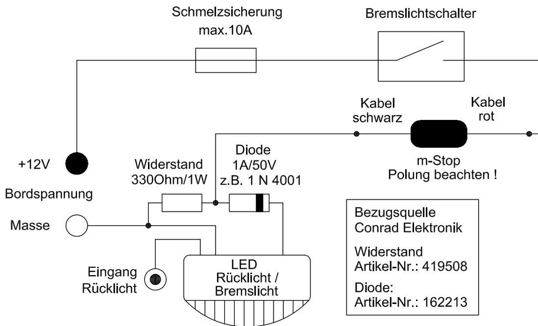
**Wenn der Anschlussplan der Bedienungsanleitung für das LED Rücklicht nicht zum Erfolg führt, ist dieser Plan zu benutzen.**
